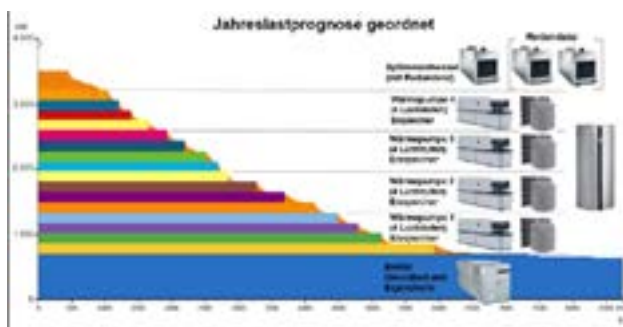
Abbildung 2: Jahreslastprognose für ein Bioenergiedorf. Heizlastabdeckung durch ein multivalentes Heizsystem mit übergeordneter Steuerung
